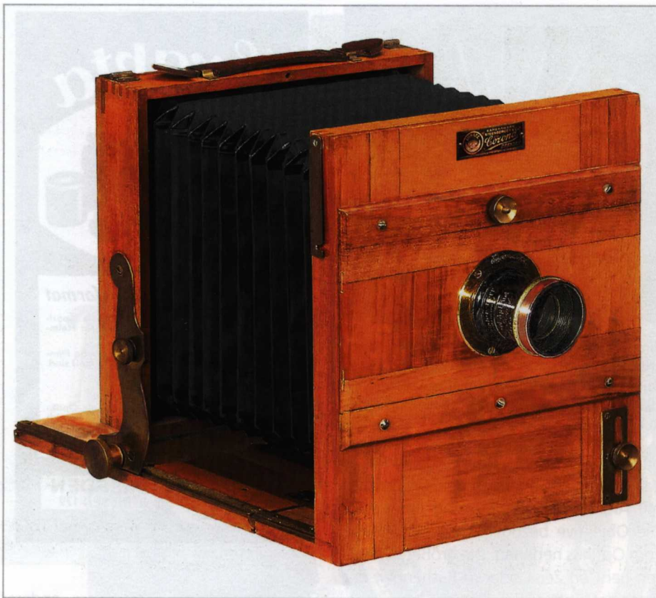
Aus dem Zusammenschluss mit Emil English entstanden bei der Ihagee in den 1920er Jahren auch noch Holzkameras – hier eine Corona 770 für Platten 13x18 cm aus dem Jahr 1922. Als Objektiv ist ein Universal Aplanat Extra Rapid der Gebrüder Urff, Braunschweig montiert. Rechts: Die Plan Paff-Reflex wurde als die „billigste Reflex-Kamera der Welt“ beworben; es gab sie bereits ab 29 RM.
