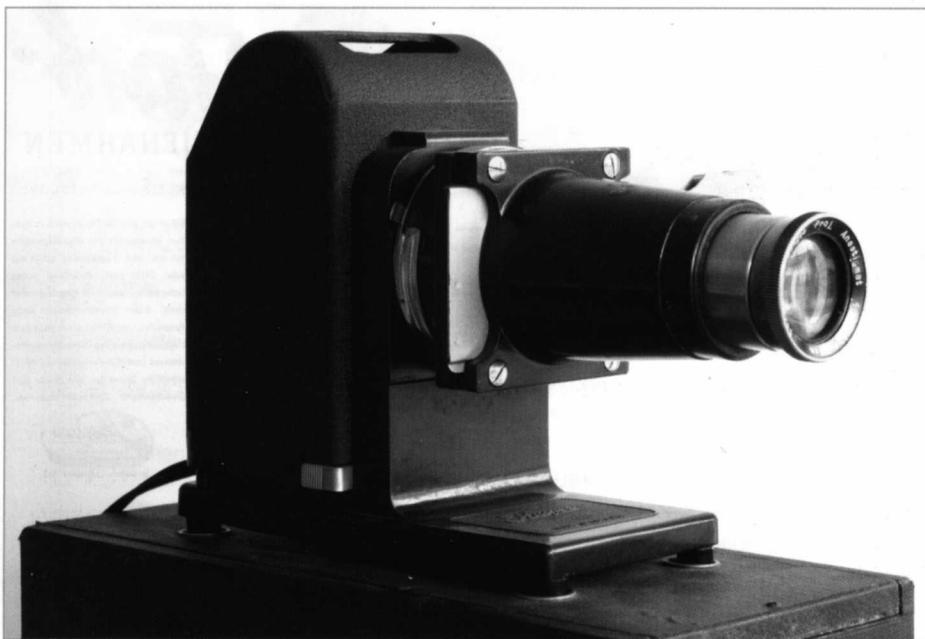
Das Ihagee Simplex-Diaskop im Betriebszustand. Die Holzkiste fungiert als Ständer und ist in der Höhe und Neigung verstellbar. Die Füße passen in vorgefertigte Aussparungen in der Oberseite des Kastens.
