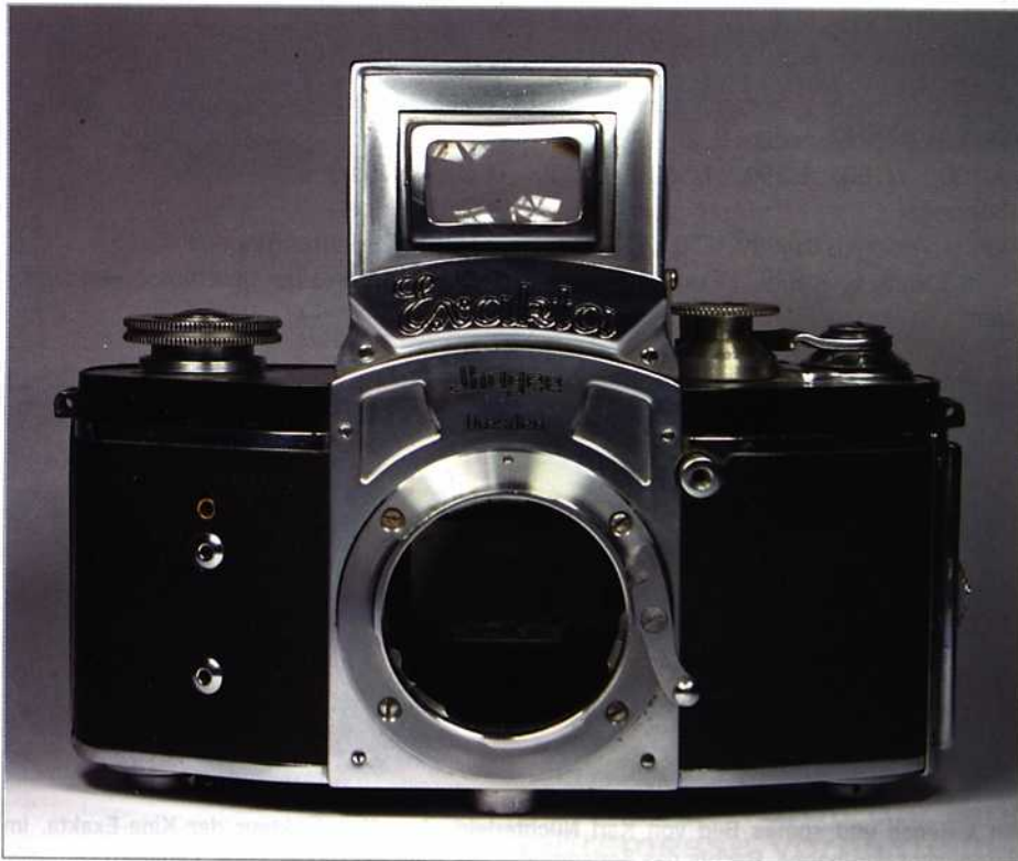
Kine Exakta Version IIIa von 1938 mit zwei Vacublitz-Buchsen und einer darüberliegenden Gewindeöffnung zur Arretierung des Blitzgerätes. Nicht nur in Deutschland, auch in den USA war die Kine-Exakta erfolgreich. Nebenstehende Anzeige datiert von 1939.
