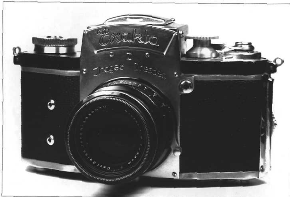
Die Kine-Exakta II löste die klassische Kine-Exakta ab. Eine Besonderheit ist der schwarze Bajonettring. Die abgebildete Kamera (V. II) ist von 1949 und mit einem passenden Biotar 1:2 F= 5,8cm ausgestattet.
