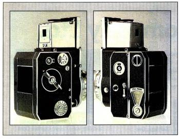
Die äußeren Bedienungselemente lassen das aufwendiges Innenleben bereits erahnen, das der Hersteller allerdings nie richtig in den Griff bekam. Zu den technischen Raffinessen zählen Wechselmagazin, Schlitzverschluß von 1/1000 bis 12 Sek., auswechselbare Sucher und Einstellscheiben und ein geteilter, schwenkbarer Doppelspiegel. der auch bei langen Brennweiten das volle Sucherbild zeigt.
