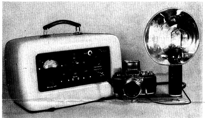
Abb. 1. Blitzgerät für wissenschaftliche Aufnahmen von Elektronik, Plauen
