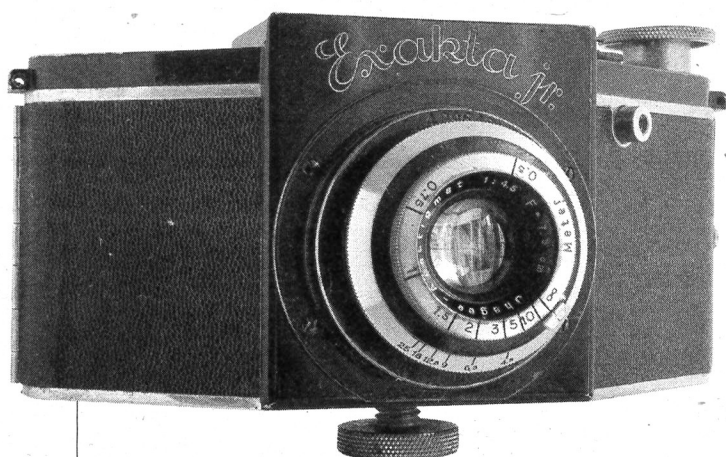
Vest Pocket Junior, vitesse limitée au 1/500 e , et sans prise flash. Objectif fixe non interchangeable. 1934.
