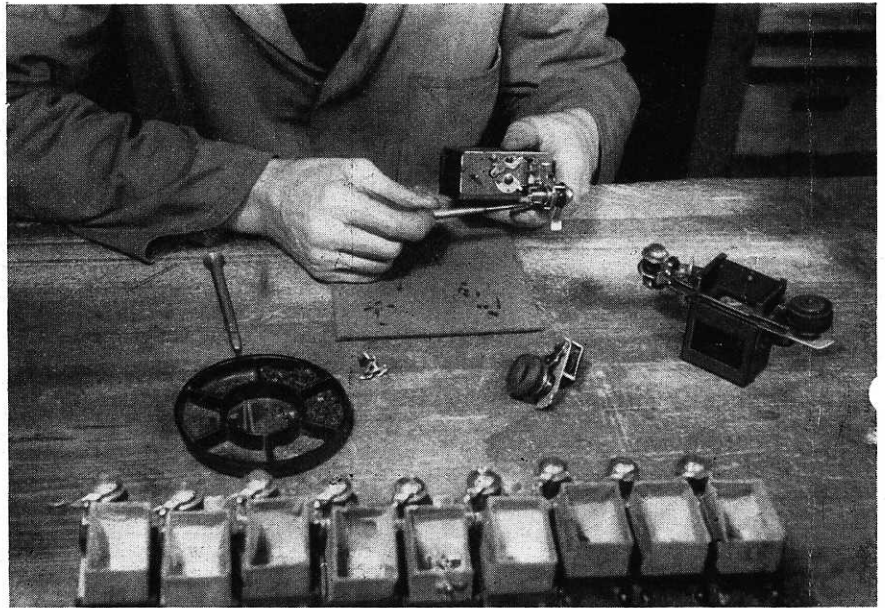
Abb. 14 Endmontage: Das Innenteil der EXAKTA Varex wird mit den Verschußplatten versehen.
