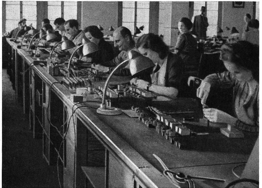
Abb. 16 Im Arbeitsraum der Endmontage werden alle Einzelteile zu einem Konstruktionsganzen vereinigt, bis die EXAKTA Varex versandfertig ist.
