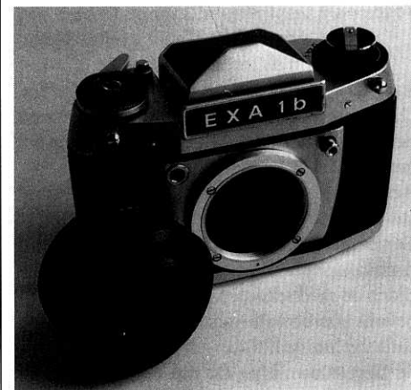
Boven: Model 1958 Onder: Model Ib, met P-draadvatting
