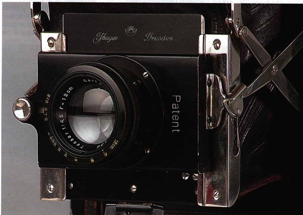
*El objetivo Carl Zeiss Jena Tessar va montado sobre un sistema que permite desplazamientos, con lo que existen posibilidades (limitadas) de corrección de líneas.*
