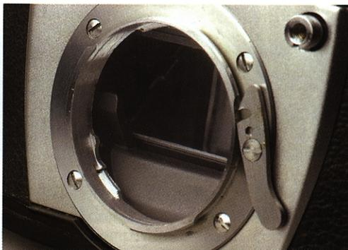
*El obturador "de pala" o "de cesta" de las Exa de estas series es único en su funcionamiento. Aquí lo podemos ver, a través de la montura para el objetivo, en su posición de "listo para el disparo". La obturación está configurada por el borde inferior del espejo y el borde superior de la "pala", aquí en íntimo contacto.*
