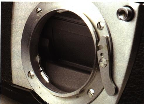
*¡La pala, o "cesta", en un recorrido parcialmente circular, ha subido, terminando la exposición! Queda perfectamente acoplada a la parte inferior del espejo. La exposición se produce, de hecho por la rendija formada entre el borde inferior del espejo y el superior de la pala o "cesta".*
