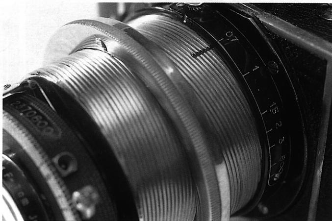
*Si se presiona ligeramente sobre la palanca situada en el lado derecho de la cámara, se libera el tope de ajuste automático a infinito, y puede llegar a enfocarse hasta 50 cm de distancia. Una ranura grabada sobre la propia helicoidal es la marca de referencia respecto a la escala de distancias solidaria del cuerpo de la cámara.*
