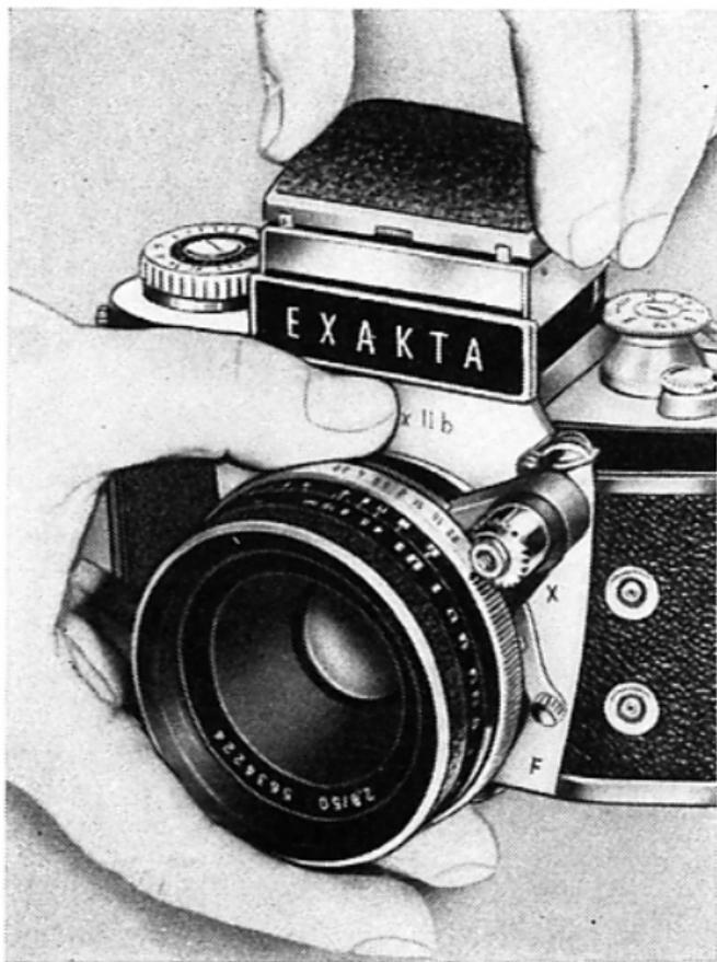
auch ein Prismeneinsatz (45) verwendet werden kann. Außerdem stehen für Nah- und Mikroaufnahmen der Objektiv-Lupen-Einsatz und für Stereoaufnahmen der Stereoeinsatz „Stereoflex“ zur Verfügung, siehe Seiten 33 und 35. – Beim Auswechseln muß der Lichtschacht (13) geschlossen sein. Lichtschachteinsatz gleichmäßig nach oben herausheben (Abb. 17). Beim Wiedereinsetzen ist der Lichtschachteinsatz genau senkrecht einzuführen und nach unten zu drücken, bis er einrastet. Niemals Gewalt anwenden!
