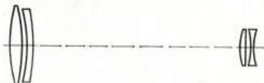
Vierlinser · Kurze Baulänge · Vorwahlblende · Ausgenutzter Bildwinkel 5° (24 × 36), 10° (6 × 6) · Kürzeste Einstellentfernung 6 m · Aufsteckdurchmesser 125 mm · Einschraubgewinde M 118 × 1 · Abschraubbare Gegenlichtblende · Drehbarer Stativsockelring · Wechseladapter (auch für PENTACON 4/300 verwendbar)
