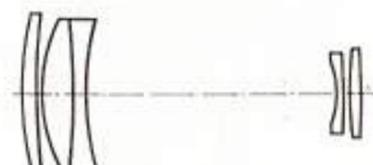
Fünflinser · Kurze Baulänge · Vorwahlblende · Ausgenutzter Bildwinkel 8° (24 × 36), 16° (6 × 6) · Kürzeste Einstellentfernung 3,6 m · Aufsteckdurchmesser 100 mm · Einschraubgewinde M 95 × 1 · Abschraubbare Gegenlichtblende · Drehbarer Stativsockelring · Wechseladapter (auch für PENTACON 5,6/500 verwendbar)
