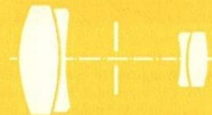
Durch eine von der üblichen Bauform der bekannten Telemegore abweichende Konstruktion sowie unter der Verwendung moderner optischer Gläser, wurde neben einer allgemeinen Leistungsverbesserung, eine Steigerung der relativen Öffnung auf 1:4,5 erzielt. Dieses für langbrennweitige Tele-Objektive erstaunlich hohe Öffnungsverhältnis erlaubt auch Aufnahmen bei ungünstigen Lichtverhältnissen oder mit kurzen Belichtungszeiten.
