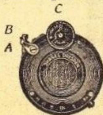
Verschuß für Zeit und Moment  $\frac{1}{25}$  —  $\frac{1}{100}$  Sekunde. Der vorstehend abgebildete **ZENITH-VERSCHLUSS** ist ein Automat-Verschuß, d. h. er ist stets gebrauchsfertig und braucht nicht gespannt zu werden. Die Aufnahme wird gemacht, indem man auf den Fingerauslöser A drückt oder, falls man dies vorziehen sollte, auf den Drahtauslöser,
