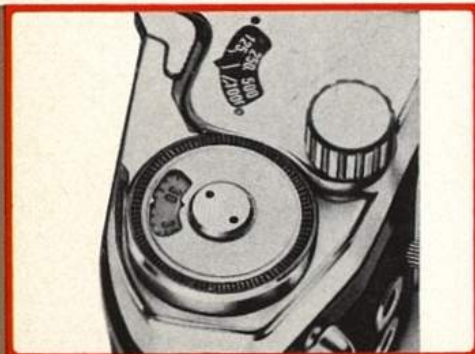
Zeitenscheibe - von 2 s bis \frac{1}{500} s „B“ und „T“ - und Blitzlichteinstellung
