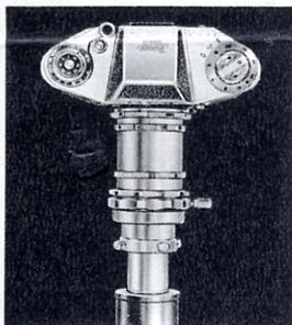
Kleinst-Balgennaheinstellgerät (mit Auslöserbrücke)
