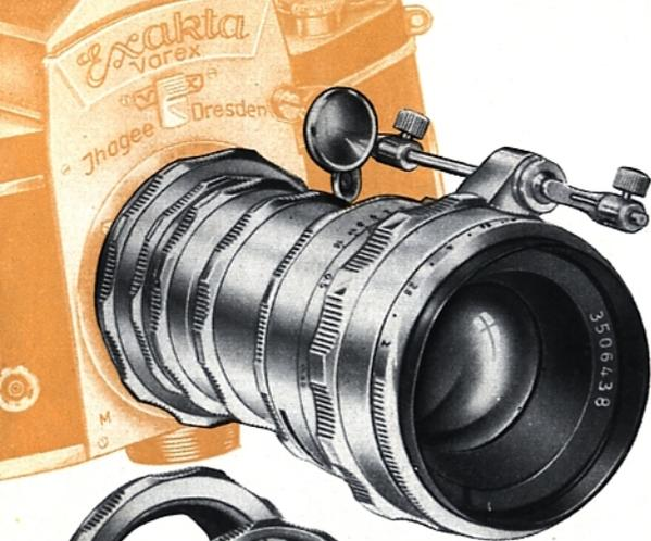
Die Bajonettringe ergeben folgende Auszugsverlängerung: Doppelbajonettring 5 mm (unterste Abb.), Bajonettringpaar (zusammengeschraubt) 10 mm, und zum Einschrauben zwischen das Bajonettringpaar gibt es drei Tuben mit 5, 15 und 30 mm Verlängerung.
