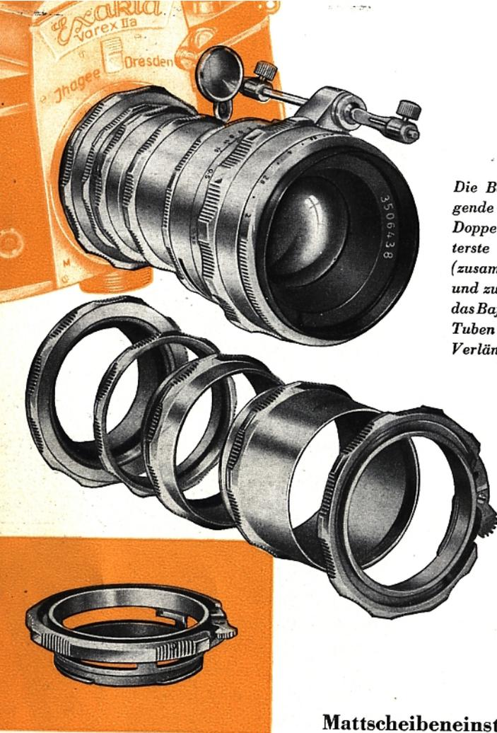
Die Bajonettringe ergeben folgende Auszugsverlängerung: Doppelbajonettring 5 mm (unterste Abb.), Bajonettringpaar (zusammengeschraubt) 10 mm, und zum Einschrauben zwischen das Bajonettringpaar gibt es drei Tuben mit 5, 15 und 30 mm Verlängerung.
