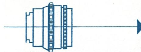
So holt ein langbrennweitiges Objektiv interessante Einzelheiten heran und sichert Ihnen außergewöhnliche Photos. Zwei Aufnahmen vom gleichen Standpunkt aus: 50 mm Brennweite und 45° Bildwinkel, 400 mm Brennweite und 6° Bildwinkel.
