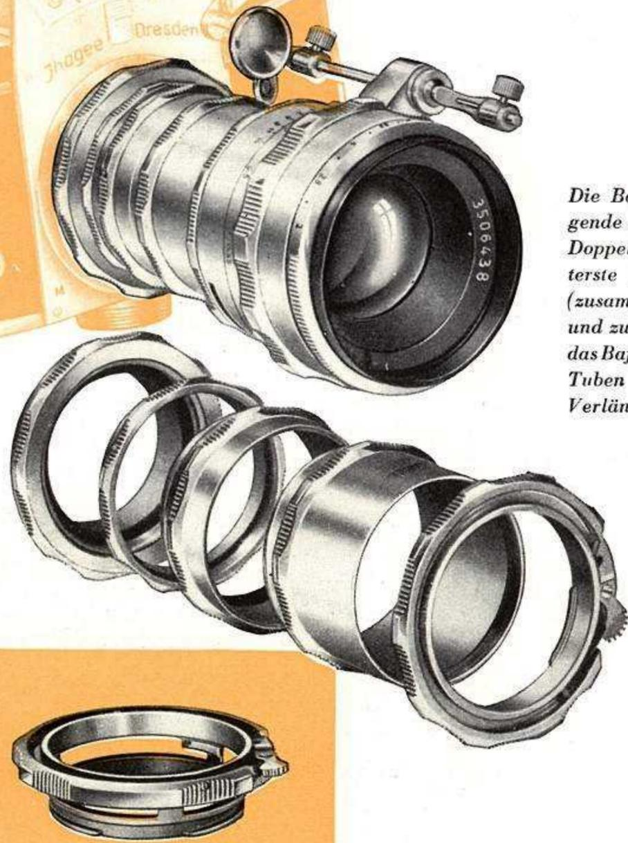
Die Bajonettringe ergeben folgende Auszugsverlängerung: Doppelbajonettring 5 mm (unterste Abb.), Bajonettringpaar (zusammengeschraubt) 10 mm, und zum Einschrauben zwischen das Bajonettringpaar gibt es drei Tuben mit 5, 15 und 30 mm Verlängerung.
