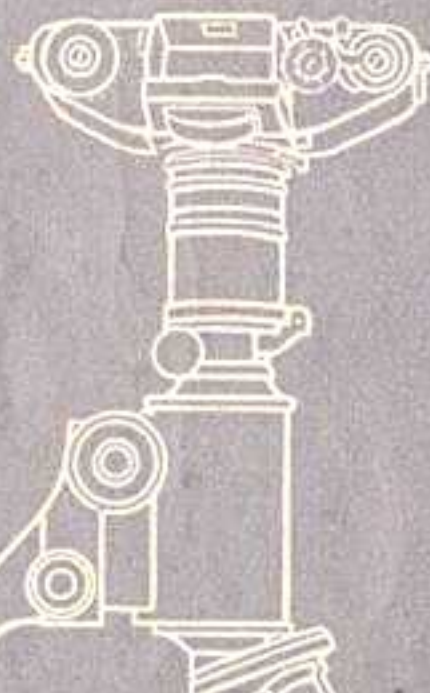
Mikrozwisehenstück mit Verlängerungstuben und Bajonettring, im Etui, lieferbar in 2. Ausführungen: Best.-Nr.
