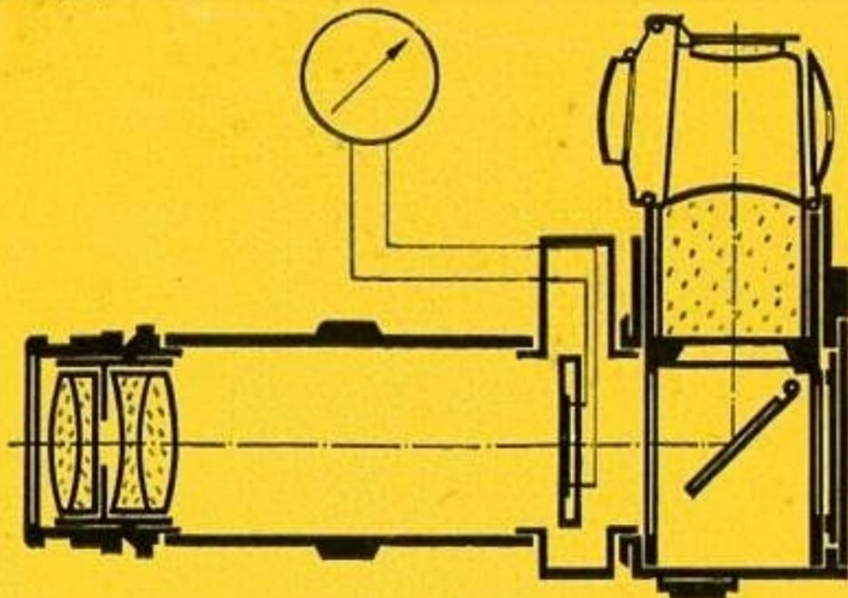
Zum Messen des in der Kamera für die Aufnahme wirksamen Lichtes wird ein Selen-Sperrschichtelement direkt in den Strahlengang eingeschoben. Der Auslöseknopf der EXAKTA Varex ist bei diesem Meßvorgang zum Verhüten von Fehlbelichtungen automatisch verriegelt.
