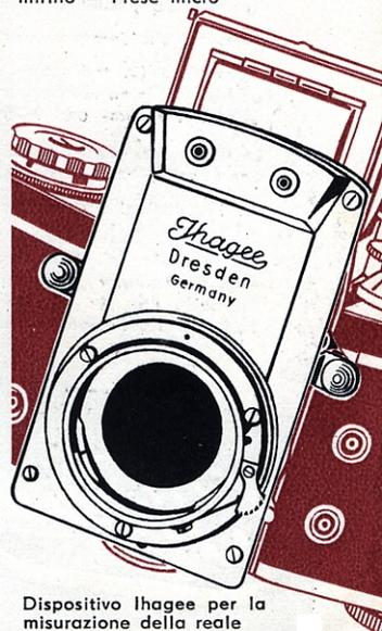
Dispositivo Ihagee per la misurazione della reale intensità luminosa
