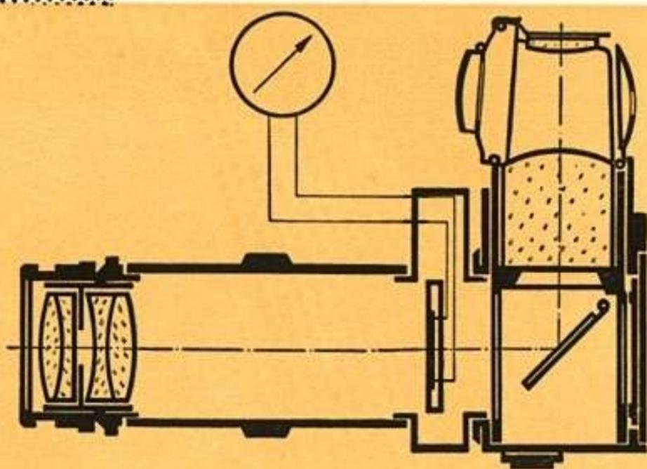
Der Auslöseknopf der EXAKTA Varex ist bei diesem Meßvorgang zum Verhüten von Fehlbelichtungen automatisch verriegelt. Vor dem Belichten wird das Selen-Sperrschichtelement wieder aus dem Strahlengang entfernt und damit der Auslöseknopf zur Betätigung freigegeben.
