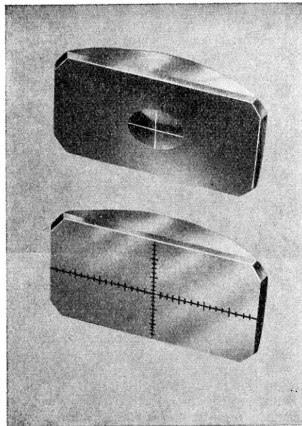
verre par la tranche et le dégager du corps de visée; introduire le nouveau verre entre les ressorts de maintien de part et d'autre des parois du corps de visée.
