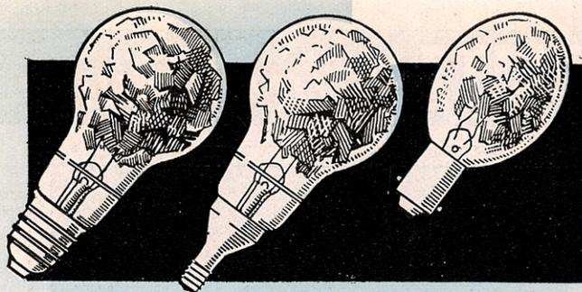
Diese verschiedenen Vakublitz lassen sich ohne besonderes Verstellen sofort in der Vakublitz-Einrichtung der Kine-Exakta verwenden.
