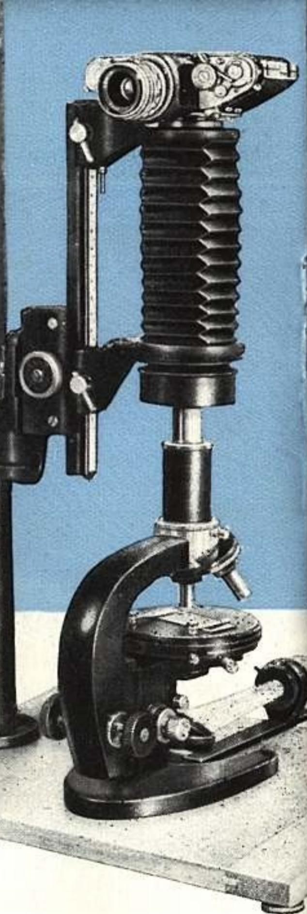
Reprogerät 1: senkrechte Arbeitsweise für Mikro- aufnahmen (Gebrauchsstellung)
